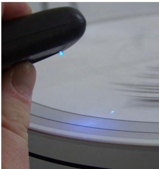
Legen Sie die *Stroboscope Testrecord* bitte mit den feinen Strichen nach oben auf Ihren Plattenteller. Auch hier haben Sie die Möglichkeit zwischen zwei verschiedenen Geschwindigkeiten zu wählen. Mit der äußeren Skala können Sie die Geschwindigkeit von 33,3 Hz messen, auf der Inneren 45 Hz. Halten Sie das Licht parallel zur Skala und regeln Sie die Motorgeschwindigkeit so lange bis die waagrechten Striche nicht mehr wandern.
